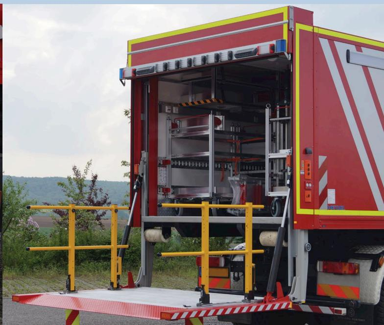
Abrollbehälter werden vorwiegend für Nachschub oder Sonderfunktionen eingesetzt. Durch deren Einsatz können verschiedenste Funktionen abgedeckt werden, ohne teure Unterhaltskosten für mehrere Fahrgestelle bezahlen zu müssen.
