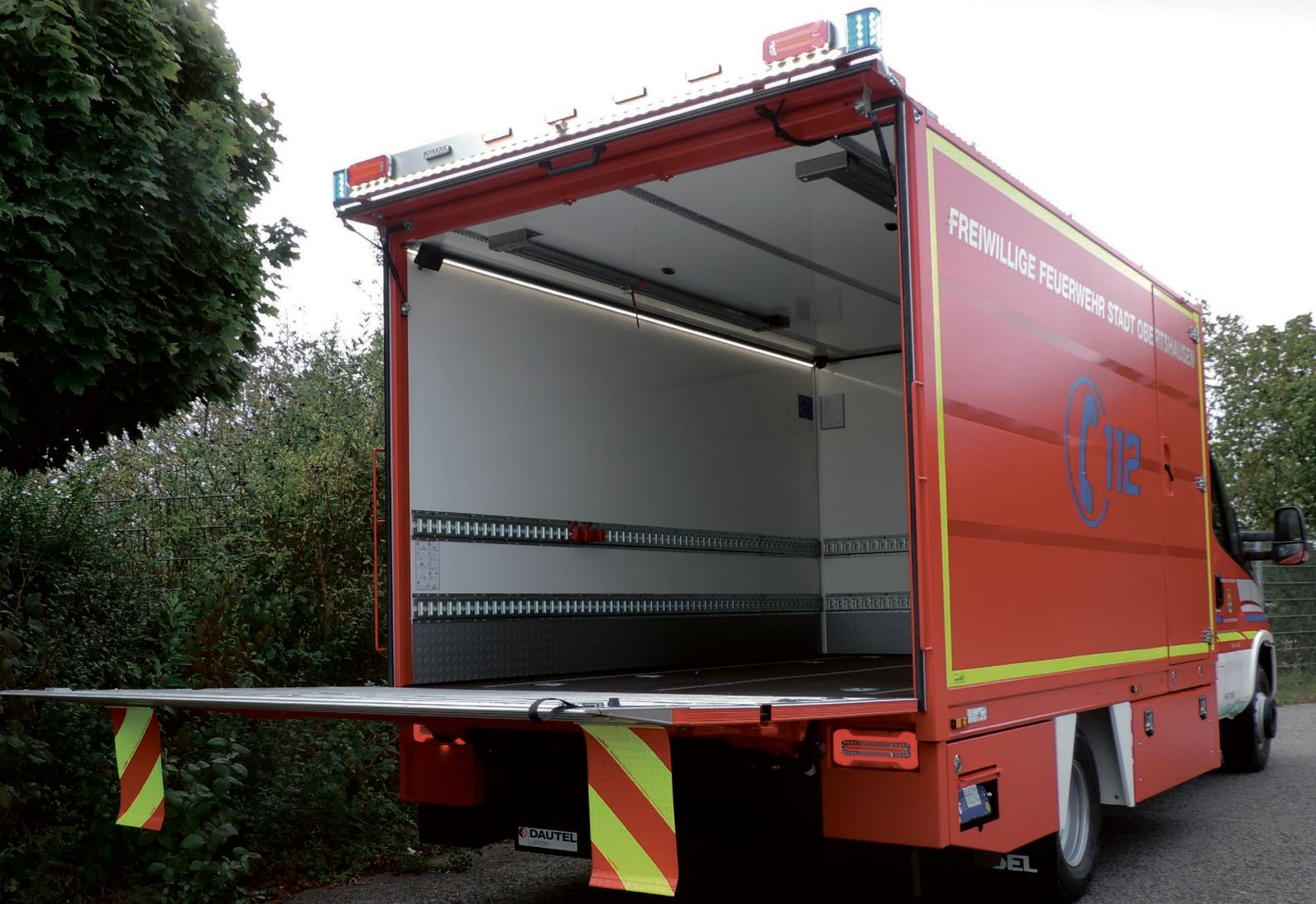
Hensel-Koffer mit 40 mm starken Seitenwänden und GFK-Deckschicht
