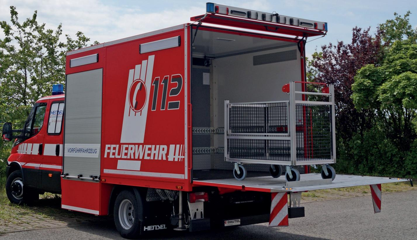
TSF-L / Tragkraft-Spritzen-Fahrzeug Logistik
